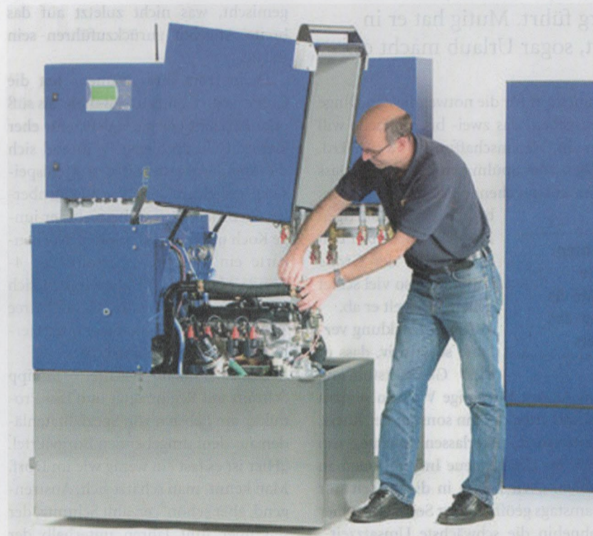
Energie gut genutzt: Blockheizkraftwerke, hier von Brockbals, arbeiten äußerst effizient. Intelligente Spültechnik von Winterhalter (unten rechts) spart durch Wärmerückgewinnung
